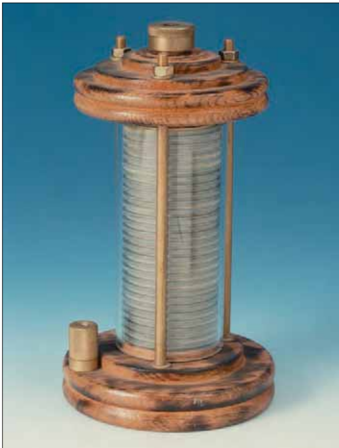
Als Urform des Akkumulators gilt die sogenannte „Rittersche Säule“, die Ritter 1802 entwickelte.
